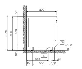
Electrical inlet (power) Equipotential screw
